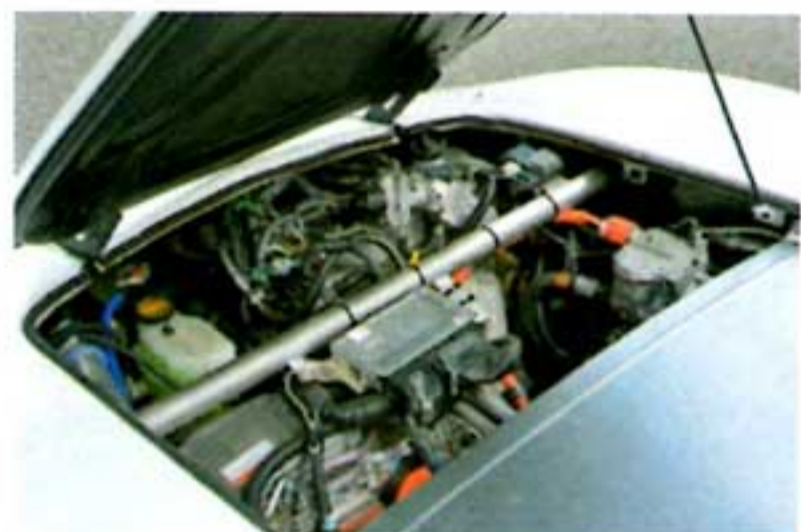
パワートレインはアクア用の1.5ハイブリッドを搭載。コンピューターがすべてを集中管理しているためスワップするのは非常に難しかったようだ。また車高や足回りとのマッチングも苦労したという。
